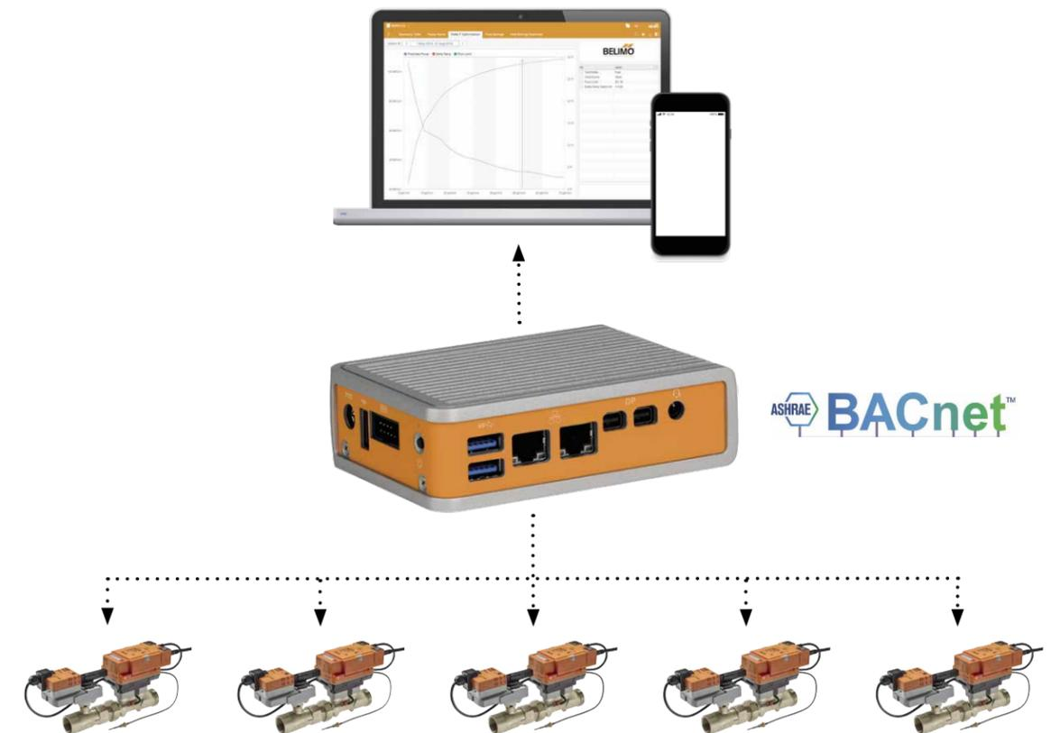
Figure 43: Belimo Clear Edge setup
